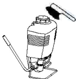
Después de usarse, la superficie del presurizador deberá ser lavado en un lugar limpio y adecuado, las partes interiores deberán ser limpiadas con una inyección de alta presión hasta que estén completamente limpios.
