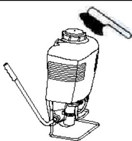
Después de utilizar el pulverizador se deberá lavar para protegerlo de cualquier corrosión de algún químico que resultara de la posible reacción entre uno residual y el siguiente en caso de que sean de diferente naturaleza el cual puede hacer daño a la cosecha o reducir los efectos del pesticida.
